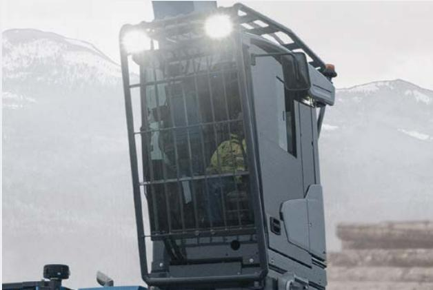
➤ Front- und Dachschutzgitter für Holzlademaschinen
