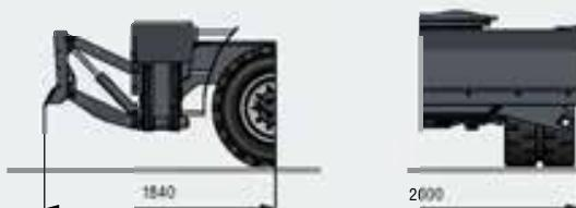
**2-point Stabilizers and support blade | 2-Punkt-Abstützung und Stützschild | 2 stabilisateurs et lame d'appui**
